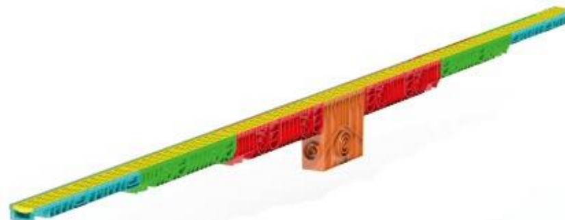
Двухсторонняя каскадная укладка лотков с использованием пескоуловителя
